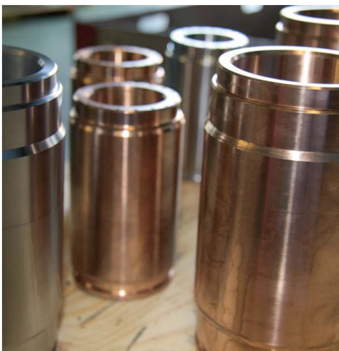
In Gold könnten diese Werkstücke aufgewogen werden, allein vom Rohstoffpreis her. Das Unternehmen Schmidlin Mechanik AG übernimmt hier die mechanische Bearbeitung, für ein Produkt, das im Kraftwerksektor eingesetzt wird.
